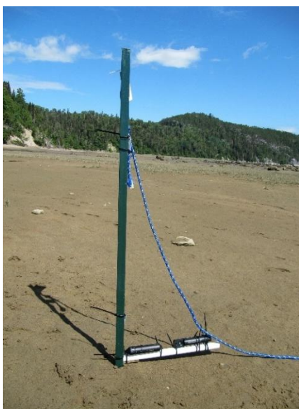
Figure 44. Station de mouillage et emplacement des différentes sondes.
